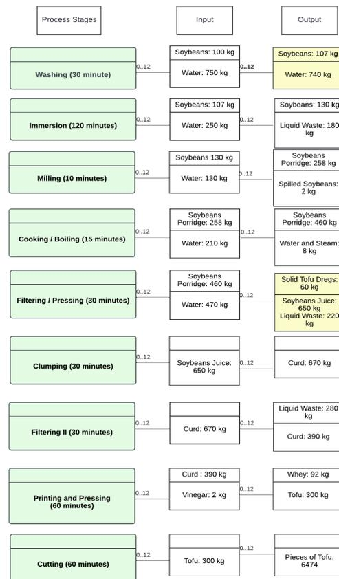
Gambar 3. Alur atau Tahap Proses Pembuatan Tahu
