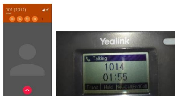
Gambar 3. 15 Tampilan panggilan *client* pemanggil (1013) pada Zoiper pada perangkat *handphone* dan penerima (1012) pada *IP Phone*
